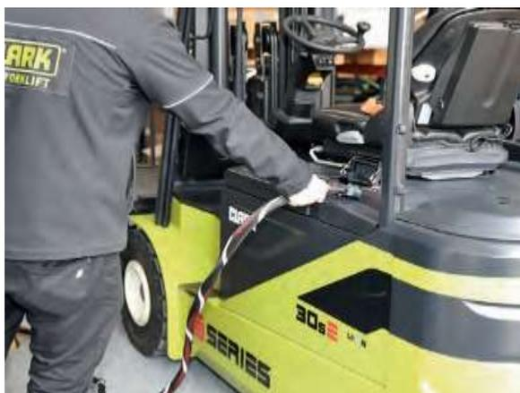
Подзарядка литий-ионного аккумулятора возможна из положения стоя без необходимости для водителя открывать капот аккумулятора.
