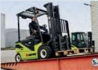
Электрические вилочные погрузчики CLARK серии SE25-35 отличаются высочайшими стандартами безопасности, например, встроенным автоматическим стояночным тормозом в стандартной комплектации. Он предотвращает неконтролируемый откат погрузчика назад даже на наклонной поверхности или при погрузке и разгрузке. Автоматический стояночный тормоз не только обеспечивает безопасность, но и гарантирует плавное и точное управление в любых условиях работы.
