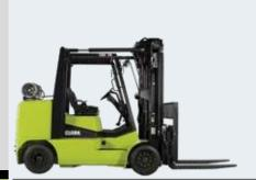
Силовая установка на сжиженном газе Бандажные шины 6000/7000 кг
