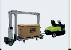
Буксирный тягач с автономным рулевым управлением грузоподъемность 1600 кг
