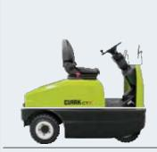
Электрический буксировочный тягач грузоподъемность 4000/7000 кг
