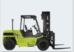
Силовая установка на дизельном топливе или сжиженном газе Суперэластик или пневматические шины 6000 / 7000 / 7500 / 8000 кг
