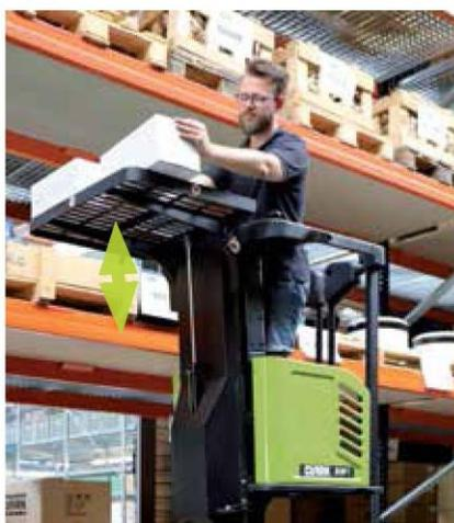
Погрузчик можно запустить только после того, как оператор встанет на рабочую платформу и защитные штанги будут закрыты. Когда рабочая платформа поднимается, защитные штанги автоматически блокируются. Предохранительные датчики, расположенные под платформой оператора, деактивируют функции перемещения, опускания и подъема при обнаружении давления на крышку под рабочей платформой.
