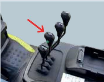
Переключатель активации VMS (Вертикальное позиционирование мачты) на механическом гидравлическом рычаге
