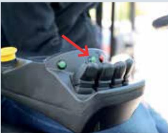
Переключатель активации VMS (Вертикальное позиционирование мачты) на мини-рычаге
