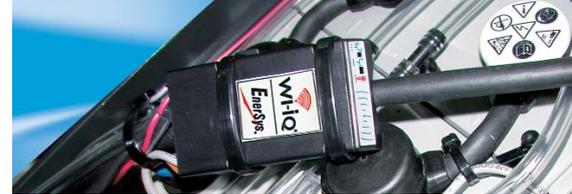
Обмен информацией дает пользователю возможность контролировать весь процесс заряда в реальном времени, а зарядное устройство будет производить автоматические корректировки в соответствии с температурой батареи и даже прерывать заряд в случаях возникновения повышенных температур.
