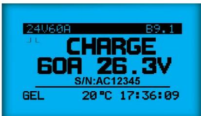
Устройство Wi-IQ, установленное на мониторах батарей, записывает данные по току, напряжению, температуре и уровню электролита в течение всего срока службы батареи. Зарядное устройство Life IQ обменивается информацией с батареей через Wi-IQ и получает все важные данные для автоматической оптимизации настроек процесса заряда.
