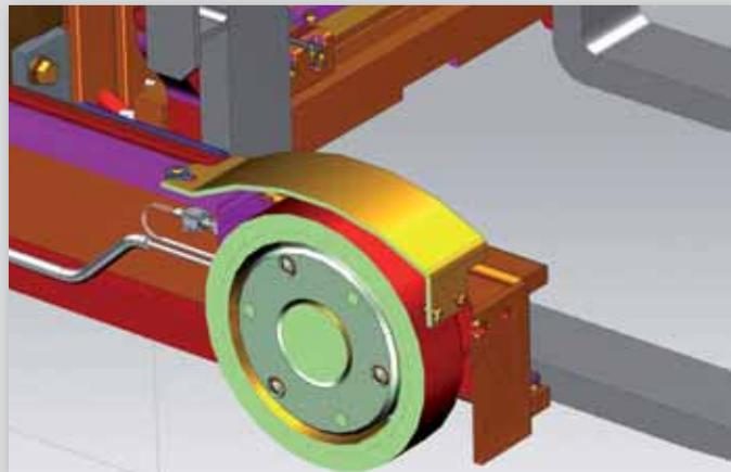
Тормоза на опорных консолях, устанавливаемые уже в стандартной комплектации, делают тормозной путь до 20% короче.
