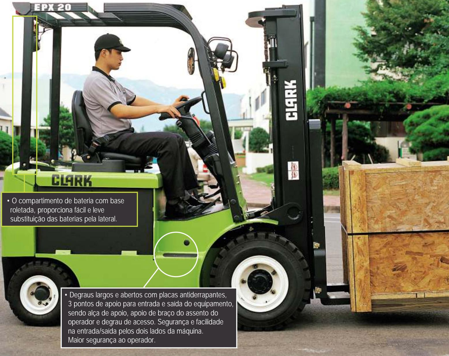
• O compartimento de bateria com base roletada, proporciona fácil e leve substituição das baterias pela lateral.
